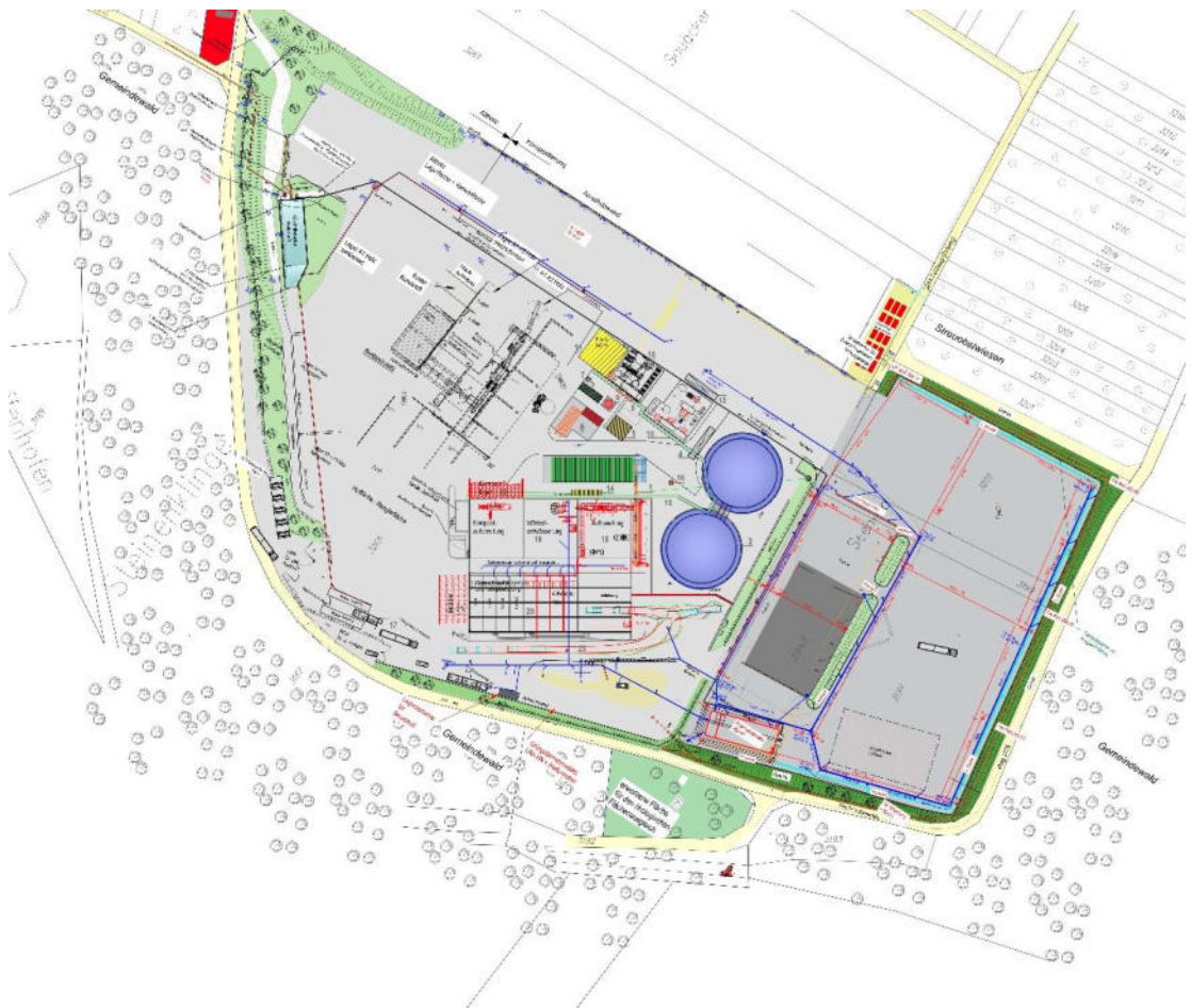
Abbildung 1. Ausschnitt (bearbeitet) aus Übersichtslageplan [7], Anlagenteile mit Biogas-lagerkapazität, die im Sinne der zu betrachtenden Dennoch-Szenarien relevant sind, sind im Bild blau durchscheinend markiert.
